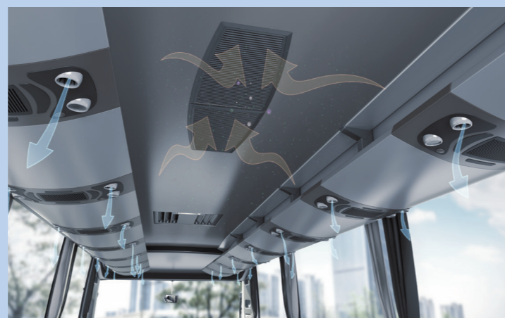
HVAC-integrierte Lösung: Kontaminierte Luft wird über das Umluftgitter angesaugt, in der Klimaanlage desinfiziert und über die Luftkanäle des Busses nahezu virenfrei im Bus verteilt.
